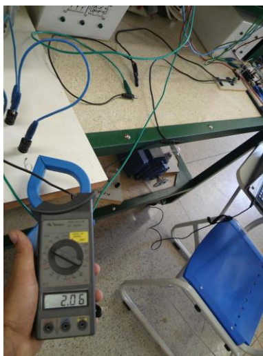
Figura 8: Medição da corrente do motor com alicate amperímetro.
