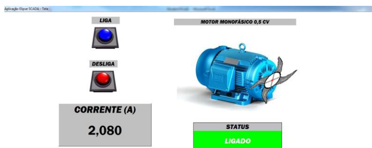
Figura 6: Tela de supervisão Elipse SCADA - modo run .
